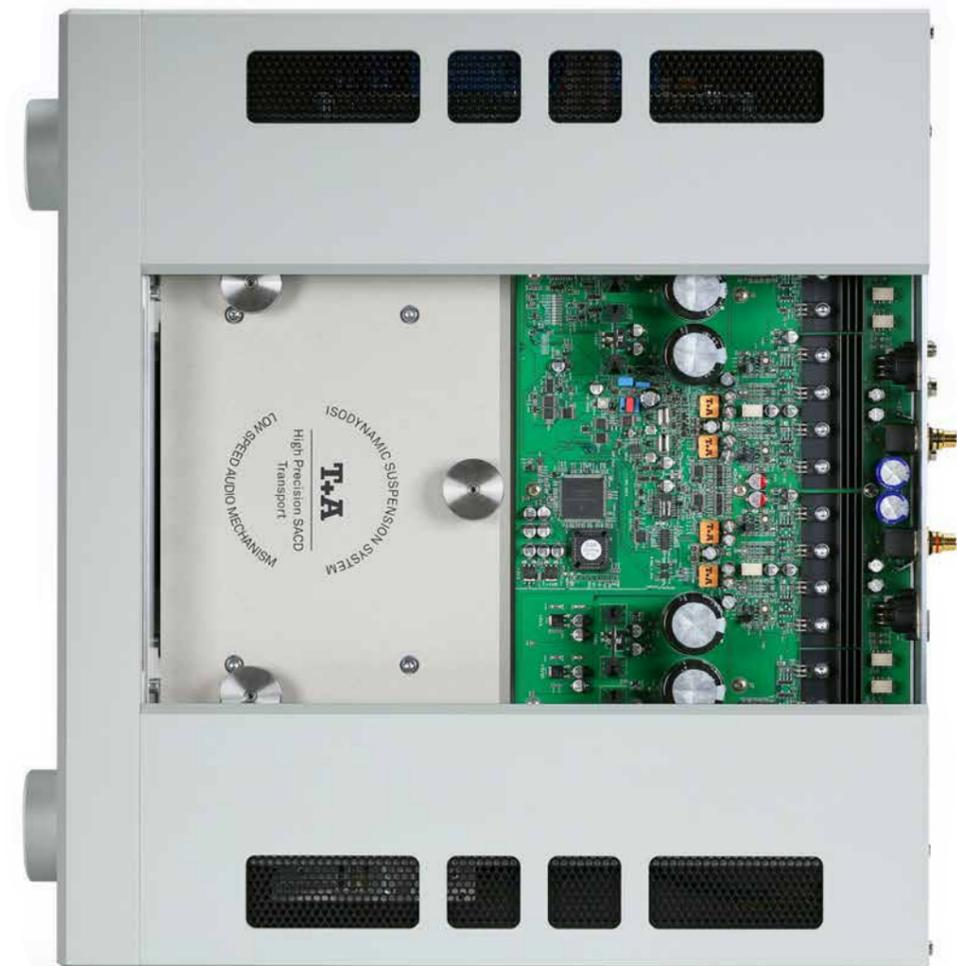
Im Inneren herrscht penible Ordnung: Fünf klar abgegrenzte Sektionen nehmen an den Geräteflanken das Schaltnetzteil für die Digitalabteilung und das mit zwei Ringkerntrafos hochgerüstete Linearnetzteil der Analogabteilung auf.
