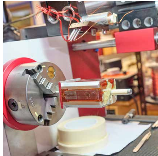
Die Maschine, die für das Wickeln der Trafospulen zuständig ist, strahlt in allen ihren Teilen höchste Präzision aus. Das gilt auch für den Rest des Maschinenparks, der zum Teil in Deutschland gekauft wurde, weil es die gewünschten Minimaltoleranzen anderswo nicht gibt.
